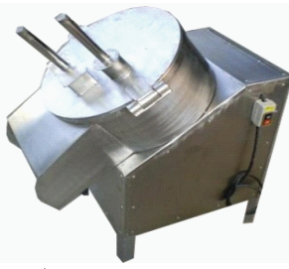
เครื่องสไลด์แผ่นผัก-ผลไม้ Vegetable and Fruit Slicing
